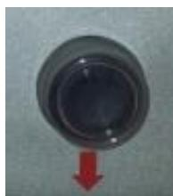
: Maintenir la bouton 3 secondes plateau descendu pour sortir les couteaux et ainsi permettre le nettoyage.
